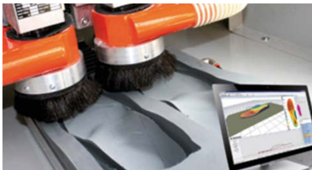
Obr. 4 Výroba stélek ve fríze
